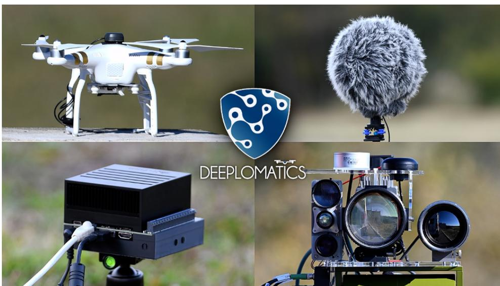
Celles-ci ont été développées conjointement pour un **ensemble de capteurs audio et optroniques**, qui permettent l'identification et le suivi robuste en temps réel de trajectoires d'aéronefs sans pilote à faible signature grâce à des données issues de capteurs hétérogènes : antennes microphoniques pour le son, et différentes caméras (visible, thermique, et imagerie active dans le proche infrarouge).
