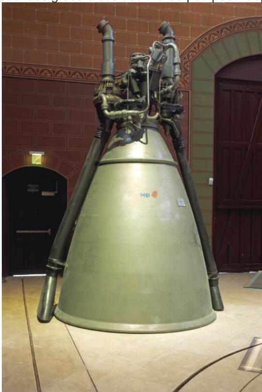
combustion en ergols et qui sont mues par des gaz de combustion produits dans le générateur de gaz unique. Ces combustibles brûlent à plus de 3000°C.
